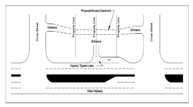
FIGURE 2-2 VEHICULAR CIRCULATION BETWEEN ADJOINING PROPERTIES
